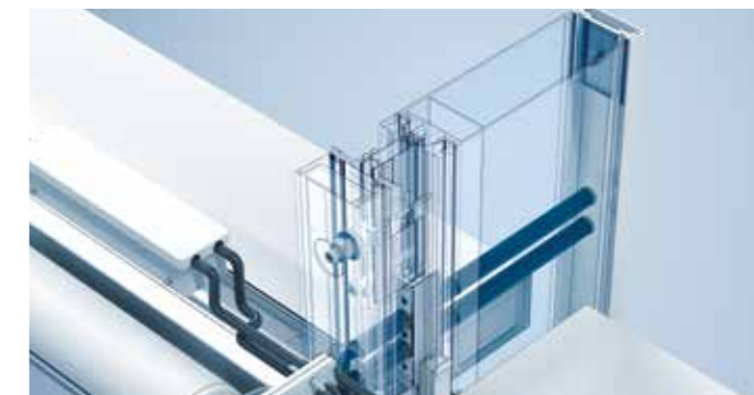
Kabeldoorvoer tussen integratieprofiel en stijl
